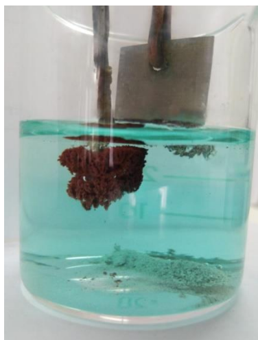
24-сурет – Тұз қышқылында тұрақты ток режимінде мельхиор электродының оңтайлы жағдайда еруі
