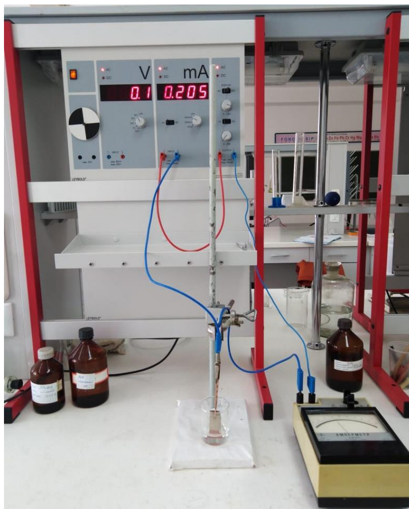
3-сурет – Мельхиор электродының электрохимиялық қасиетін зерттеу барысында қолданылған қондырғы
