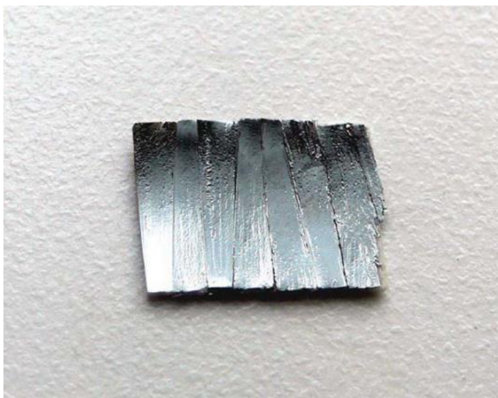
2.3.-Сурет- Рентгендік зерттеулер үшін шыны параққа бекітілген балқытылған таспа.
