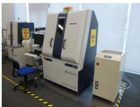
2.3.1-Сурет-: сурет: сол жақта smartLAB, Rigaku Corporation (Technoplaza, Shibaуra) [156] және кесте сипаттамалары оң жақта.
