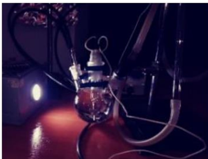
2.9-сурет– а) ФОТОИНДУКЦИЯЛАНҒАН судың ыдырауына арналған PEC ұяшықтары; б) волюметриялық қондырғының схемалық бейнесі
