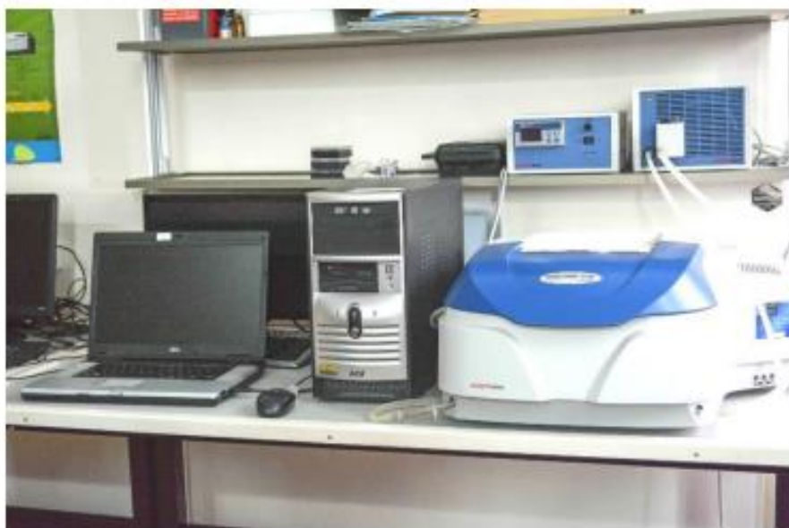
2.5-сурет – Фото УК-көрінетін спектрофотометр Specord® plus
