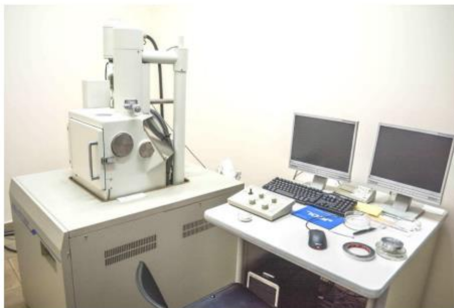
2.3-сурет – Фото СЭМ JSM-6490 LA (JEOL)
