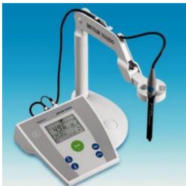
2.6-сурет – S30 кондуктометрiнiң суретi
