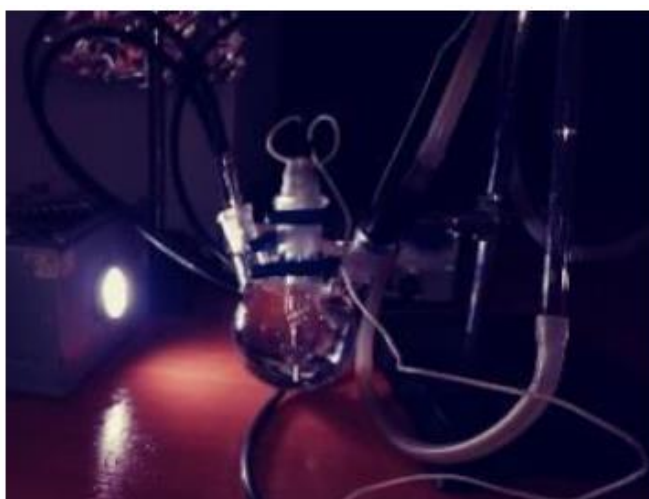
2.7-сурет – а) ФОТОИНДУКЦИЯЛАНҒАН судың ыдырауына арналған PEC ұяшықтары; б) волномериялық қондырғының схемалық бейнесі
