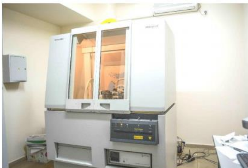
2.4-сурет – Фоторентген-дифракциялық анализатор X'pert PRO
