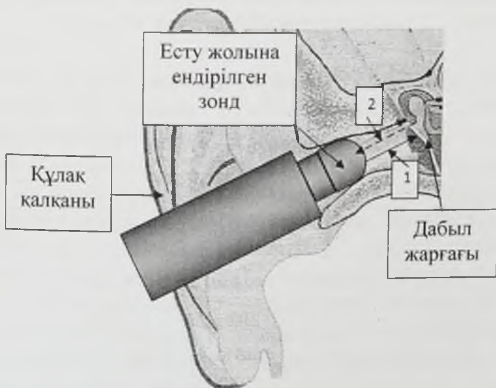
14-сурет. Тимпанометриялық құралды есту жолына орналастыру. 1- зондтан тараған дыбыс толқыны, 2- дабыл жарғағынан шағылған дыбыс толқыны.
