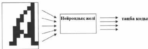
4.7-сурет. Таңбаларды тану есебіндегі нейрондық желі
