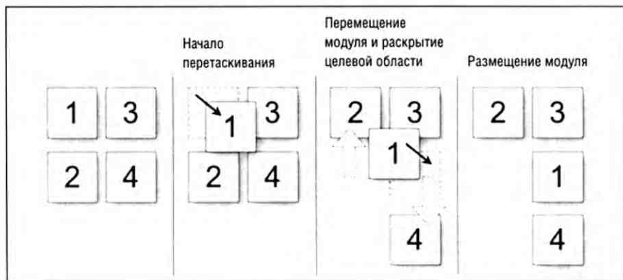
Рис. 2.5. Пунктирная рамка указывает, где будет расположен модуль после того, как пользователь отпустит кнопку мыши; модуль 1 перемещается из верхнего левого угла к нижнему правому, занимая место между модулями 3 и 4
