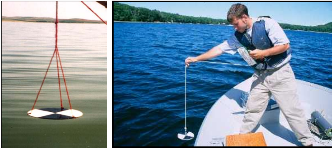
Şekil 3.18. Işık Geçirgenliğinin Secchi Disk ile Ölçülmesi (134)
