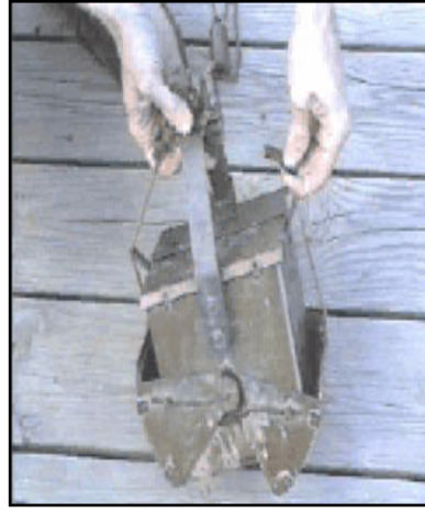
Şekil 4.1.Su Altı Bitkileri ile Su Altı-Yüzen Bitkilerin Örneklenmesinde Kullanılan Eckman Dredge (54)
