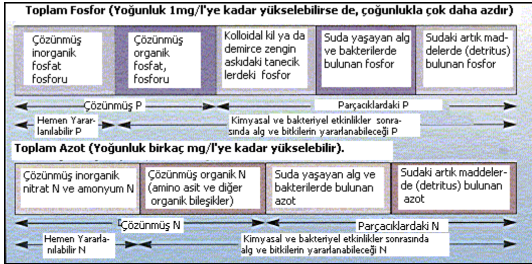
Şekil 3.22. Toplam fosfor ve toplam azot terimlerinin anlamının açıklanması. Bir su örneğinde bulunan elementlerin toplam miktarı büyük kutular içindekilerin tümüdür. Nitratların toplamı ile ender olarak bulunan nitritlerin toplamı oksitlenebilen toplam azot olarak adlandırılmaktadır. Nitrat, nitrit ve amonyum'un toplamı da çözünmüş inorganik azot olarak adlandırılmaktadır (227).
