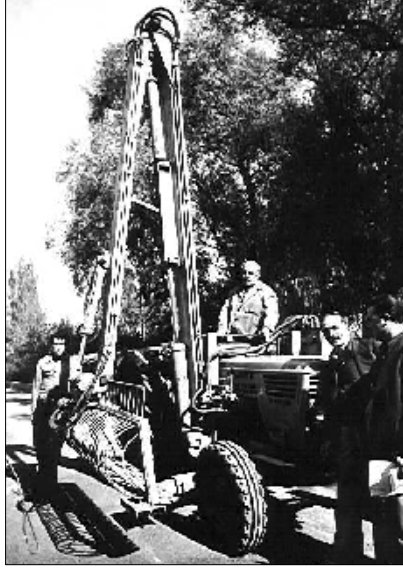
Şekil 5.14. Biçme Kepçesi Genişliği 4 m Olan Hidrolik Kollu İş Makinesi
