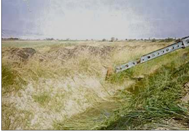
Şekil 5.17.Biçme Kepçesi Takılmış Uzayıp Kısalabilen Kolları Bulunan (teloskopik boom) Makine ile Biçme Uygulaması
