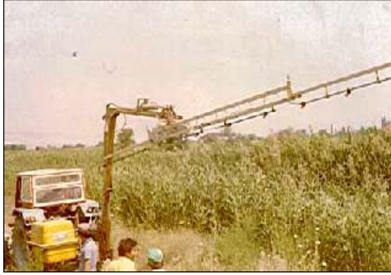
Şekil 7.10.Boşaltma Kanallarında, Halat Yöntemi ile Uygulama Yapılması
