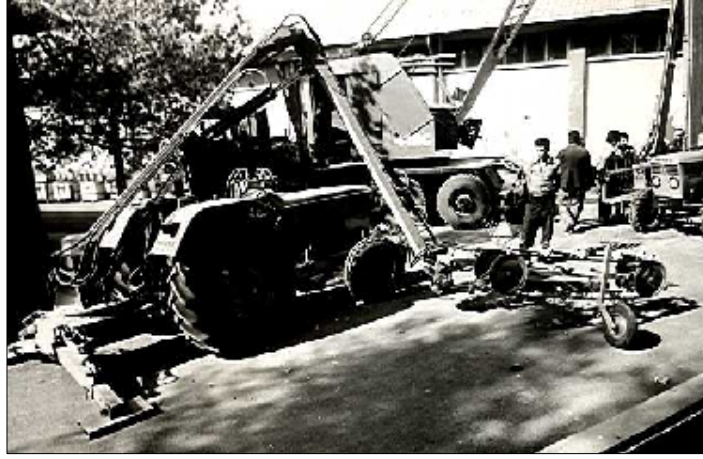
Şekil 5.15. Biçme Kollu Yabancı Ot Tırmığı Takılmış Hidrolik Kollu İş Makinesi
