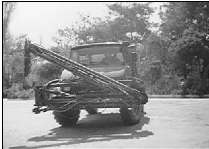
Şekil 8.4.Kendi Yürür Hidrolik Püskürtme Kollu Hoegen-Dijkhof Marka Püskürtücü
