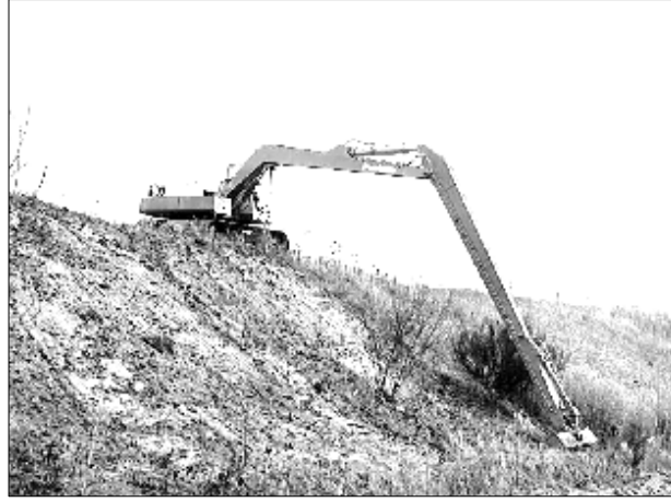
Şekil 5.16. Erişim Uzaklığı 16 m Olan ve Yabancı Ot Biçme Kepçesi Takılabilen Hidrolikli İş Makinesi
