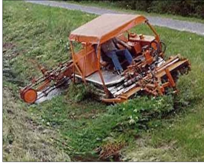
Şekil 5. 22. Değişik Eğimli Yamaçlarda Çalışabilen Biçme Makinesi
