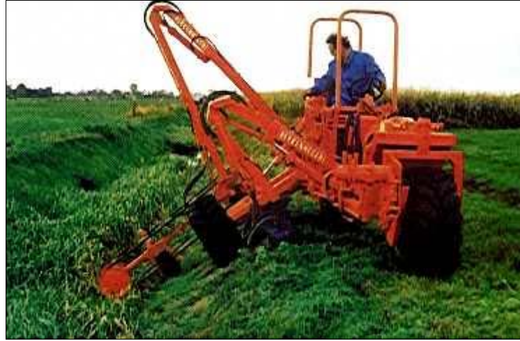
Şekil 5.23. Bisiklet Traktör. Hidrolikli Olarak Sürülen 3 Tekerlekli Makine (Tekerleklerden ikisi bisiklette olduğu gibi aynı hat üzerindedir. Üçüncü tekerlek hidrolik bir kol üzerinde bulunur ve kanalın tabanında ya da kıyılarından birinde hareket eder. Diğer 2 Hidrolik kola ise biçme düzenekleri takılır)
