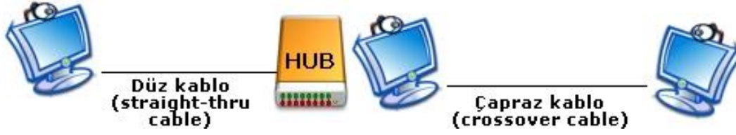
Şekil 2.8: Düz ve çapraz kablo bağlantısı
