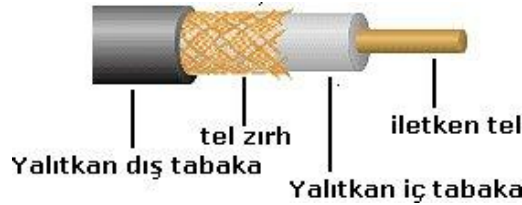
Şekil 2.11: Koaksiyel kablo iç yapısı
