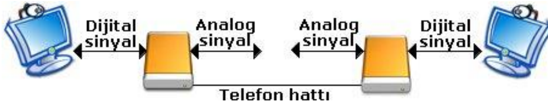
Şekil 2.9: Modem çalışma prensibi
